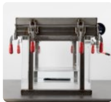
为了测试 IPX7/8 级别的浸水防护能力, Apple 将 iPhone 浸入加压容器中, 以模拟在水下受到的压力。
