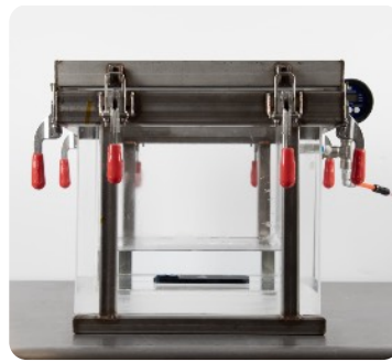
Pri testovaní ochrany pri ponorení do vody IPX7/8 sa iPhone ponorí do tlakovej nádoby, čím sa simuluje tlak pod vodou.
