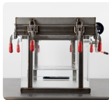
Lai pārbaudītu IPX7/8 atbilstošu aizsardzību pret iegremdēšanu ūdenī, Apple iemērc iPhone traukā zem spiediena, lai modelētu apstākļus, kādi ir zem ūdens.
