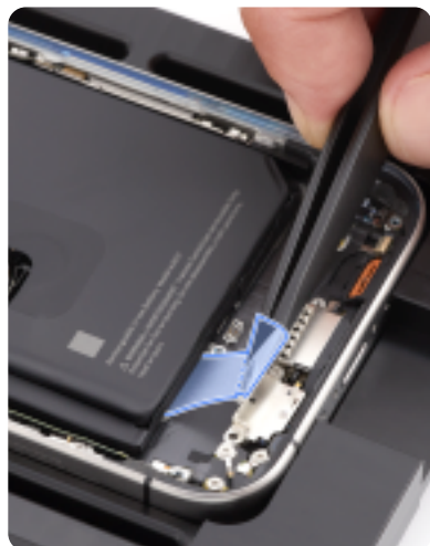
iPhone のバッテリーは、特定の方向に引き伸ばした場合に取り外すことができるように設計された、高度な接着剤を使用して固定されているため、交換が可能です。
