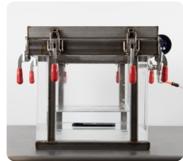
Um den Schutz bei Eintauchen in Wasser gemäß IPX7/8 zu testen, taucht Apple das iPhone in einen Druckbehälter, in dem Unterwasserdruck simuliert wird.
