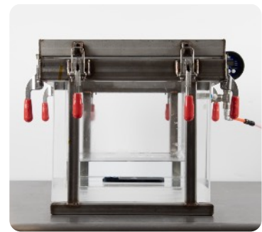
For at teste for IPX7/8-beskyttelse mod nedsænkning i vand nedsænker Apple iPhone i en trykbeholder for at simulere det tryk, der opleves under vand.
