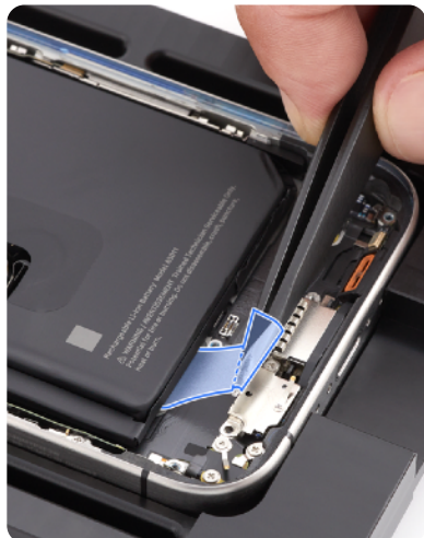
Батериите на iPhone са закрепени с помощта на усъвършенствани лепила, които са проектирани да се освобождават при разтягане в определена посока, което позволява подмяната на батерията.
